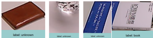
図 8: 差分画像処理による物体検知の例。左: 物体検知の成功例。中央: 差分画像処理による物体検知に失敗し、影を物体と誤認識。右 2 枚: 同一物体が分離して検知された例。
